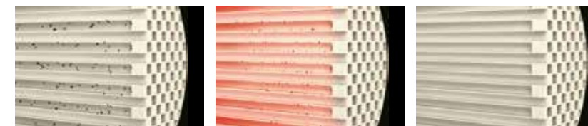
1. Materie de particule blocată 2. Debutul regenerării 3. Finalizarea regenerării*
